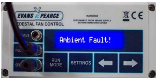
Lorsque le capteur de température du grain est manquant ou défectueux, l'erreur suivante s'affiche:
