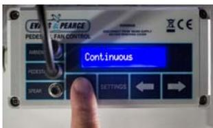
Appuyer 1 fois : Continuous: Le ventilateur fonctionne continuellement sans référence au contrôle différentiel.
