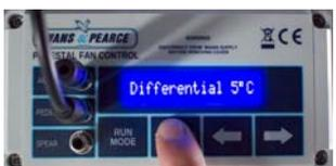
**Appuyer 4 fois** : Differential: Réglez le différentiel de température avec lequel vous souhaitez que le ventilateur fonctionne. (Par défaut 4 ° C). Cela signifie que le ventilateur ne fonctionnera que lorsque l'air ambiant est de 4 ° C plus frais que la température du grain.
