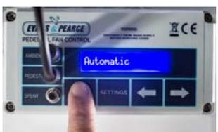
Appuyer 3 fois : Automatic: Fonctionne uniquement lorsque la température différentielle préétablie est atteinte. Le réglage par défaut est de 4 ° C. **Voir section 3.**
