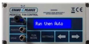
Appuyer 2 fois : Run then Auto: Le ventilateur fonctionne continuellement jusqu'à ce qu'une température de récolte prédéfinie (15 ° C par défaut) soit atteinte, puis il passe à la commande de température différentielle.
