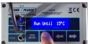
**Appuyer 3 fois** : Run Until: Permet de régler la température du grain que vous souhaitez atteindre avant que le ventilateur ne passe au contrôle de la température différentielle (15 ° C par défaut). Pertinent seulement si vous utilisez le mode RUN then Auto.
