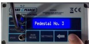
**Appuyer 1 fois** : Pedestal No: Permet d'attribuer la cheminée dans le bâtiment utilisé par le ventilateur à partir du numéro 1-32 (uniquement nécessaire lors de l'utilisation conjointe avec Data Control).
