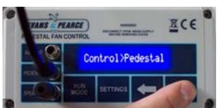
**Appuyer 6 fois** : Control: Dans le cas improbable où les capteurs de température du grain et de la cheminée sont branchés. Choisissez la température d'entrée avec laquelle le contrôleur de température différentielle fonctionnera. Cette option ne s'affiche pas si un seul capteur de température est branché.
